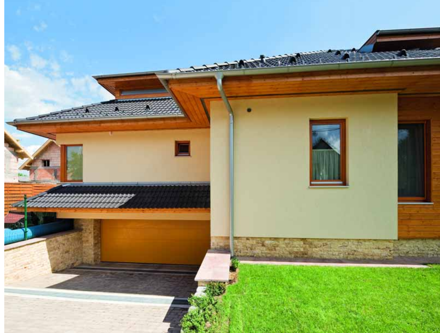
A garázslehajtó enyhe és ezért biztonságos, kényelmes lejtését a kapu hátrahúzásával sikerült megvalósítani.
